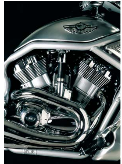
V2-Motor mit 115 PS für die V-Rod von Harley-Davidson.
