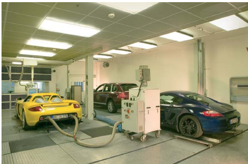
Porsche-Fahrzeuge absolvieren in der Klimadruckkammer im Abgaszentrum des Entwicklungszentrums Weissach verschiedene Testläufe.
