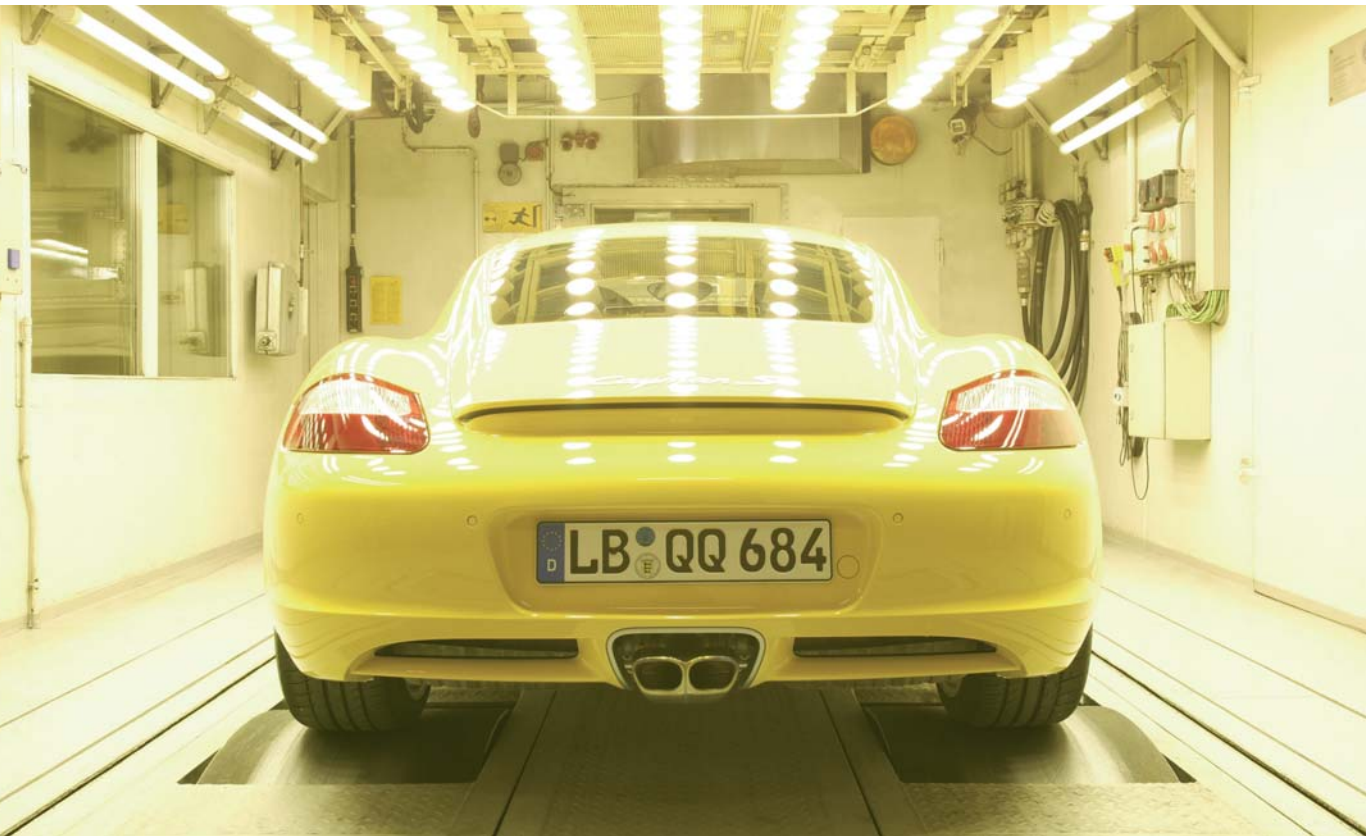
Der Cayman S im Klimawindkanal des Forschungs- und Entwicklungszentrums Weissach. Hier können reale Strecken, wie beispielsweise der Townes Pass in den USA, unter realen Klimabedingungen nachgefahren werden.
