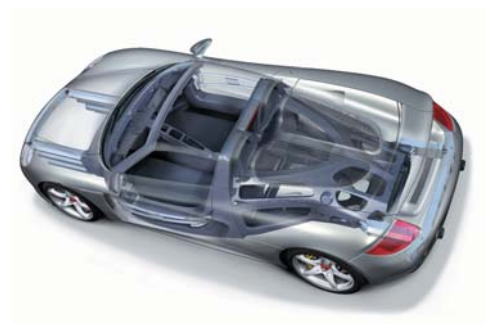
Neben Monocoque und Aggregateträgern des Carrera GT wurden zahlreichen weitere Komponenten aus mit Kohlefaser verstärktem Kunststoff (CfK) gefertigt.
