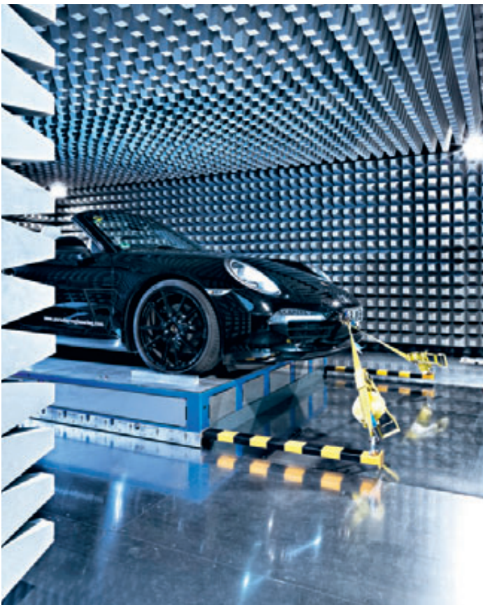
Die neue Generation des 911 Carrera Cabriolet wird auf dem Rollenprüfstand getestet
