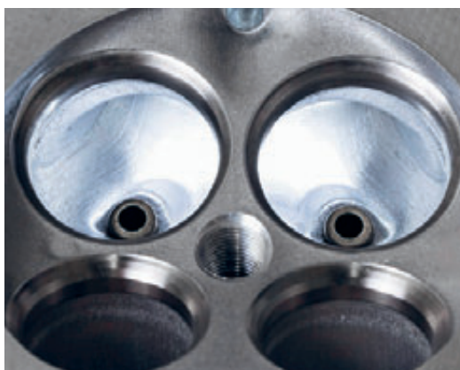
Gegenüber der Serienversion (linke Abbildung) wurden die Einlasskanäle der Zylinderköpfe beim Leistungskit des 911 Carrera S zusätzlich bearbeitet und poliert (rechte Abbildung).
