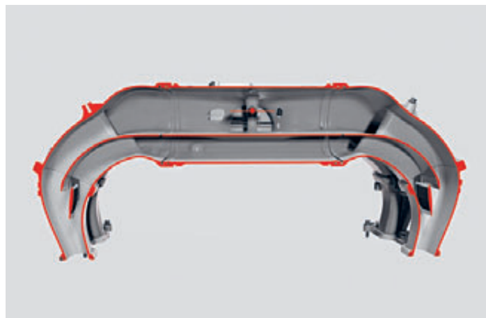
Verbesserung des Drehmomentverlaufs im Teillastbereich: Die Aluminiumguss-Sauganlage verfügt im Sammlervolumen über eine Resonanzklappe, die eine Trennung der beiden Zylinderbänke voneinander ermöglicht.
