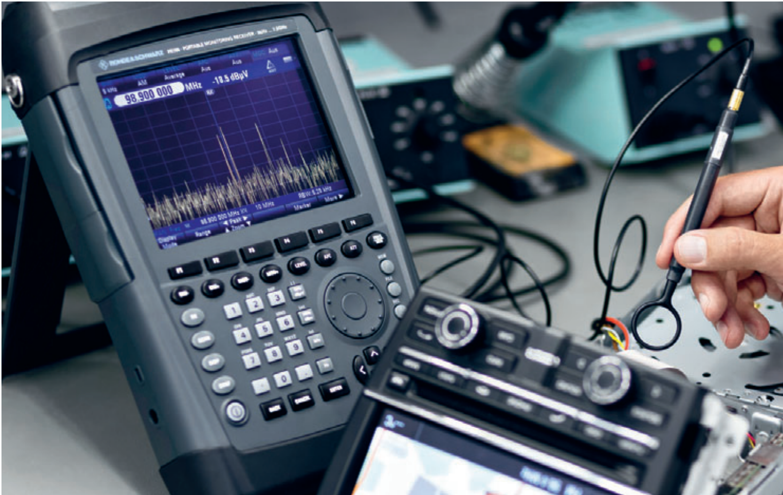
Analyse der Störquellen mit Untersuchung der Koppelpfade an einer Fahrzeugkomponente
