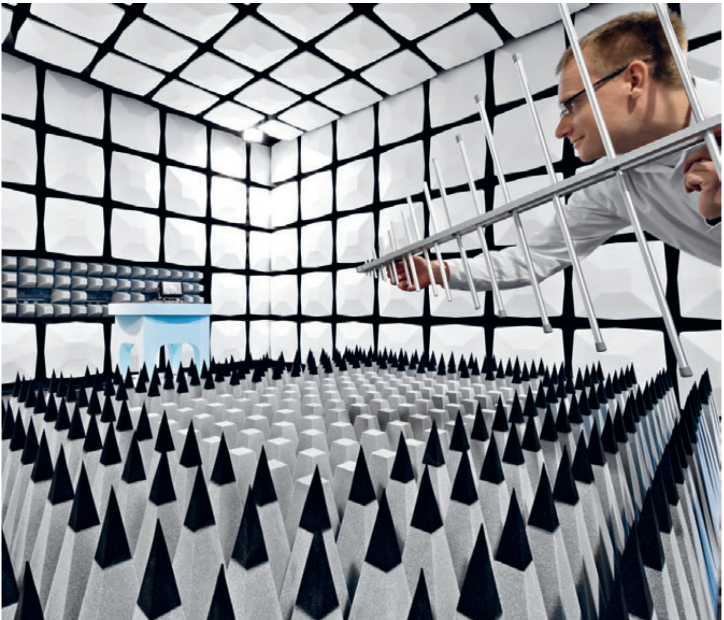
In der Vollabsorberhalle wird eine Störausstrahlungsmessung durchgeführt
