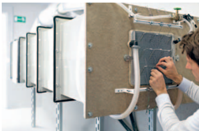
Vorbereitung eines Kühlers am Prüfstand
