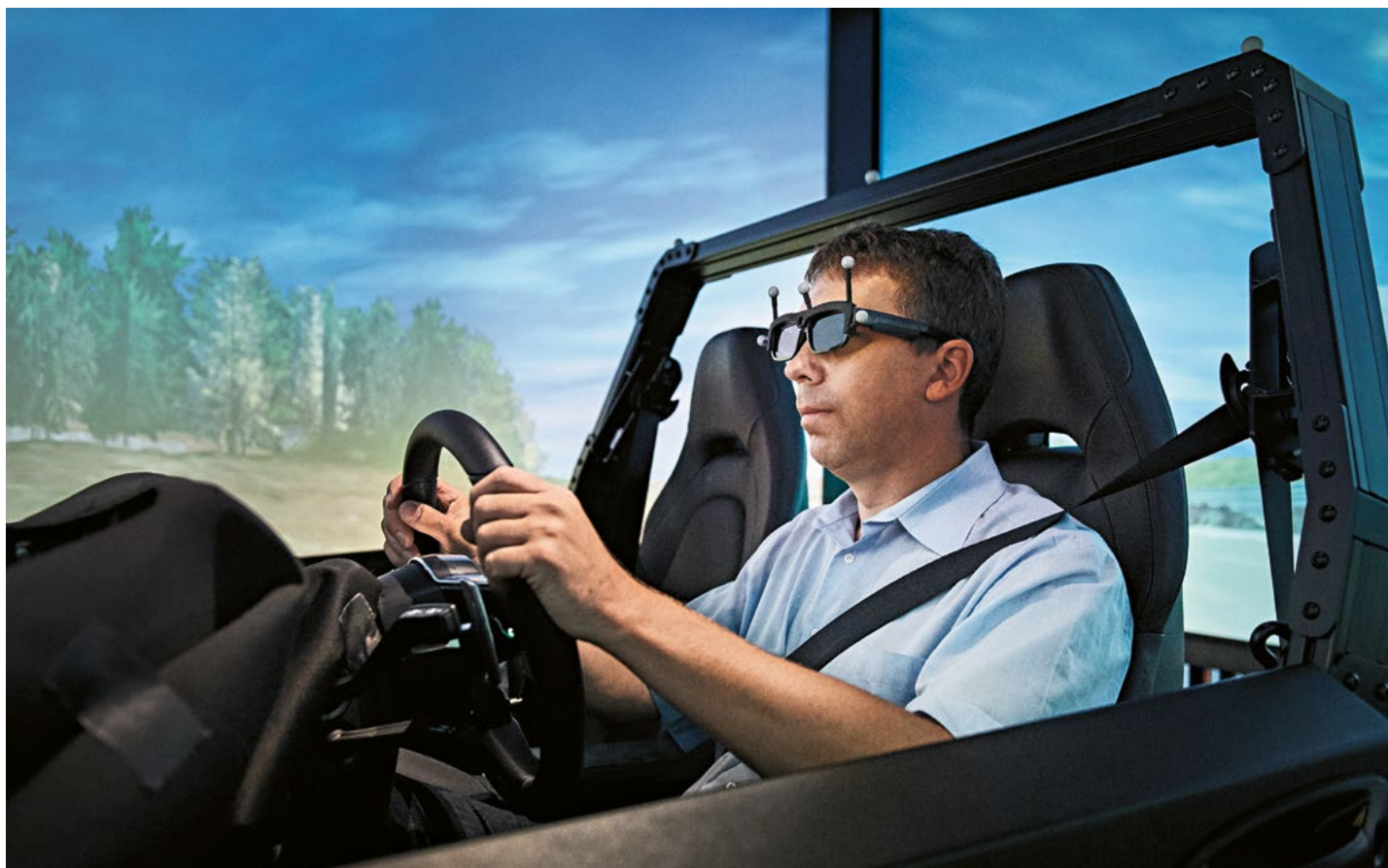
Am Steuer eines virtuellen Fahrzeugs: Die getrackte 3D-Brille sorgt dafür, dass der Fahrer die physikalisch korrekte Perspektive räumlich wahrnehmen kann. Genau wie beim echten Fahren ist der Fahrer aus Sicherheitsgründen angeschnallt.
