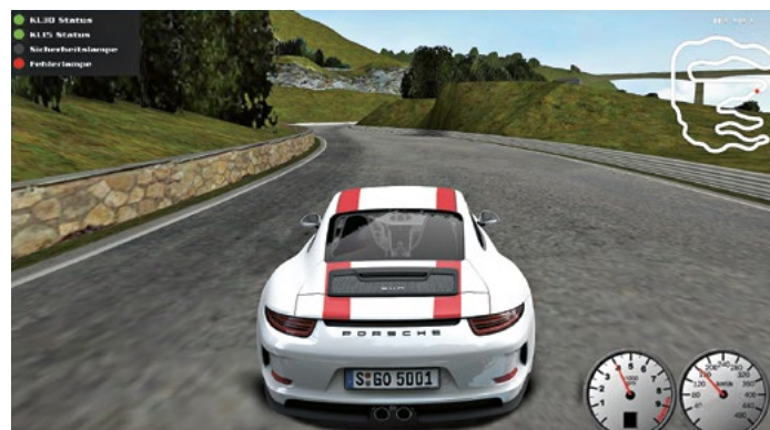
Visualisierung des Lenkungsverhaltens auf dem HiL (auf Basis TORCS, The Open Racing Car Simulator licensed under the GPL)
