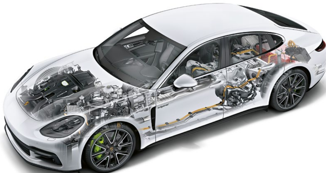
Antriebskomponenten des Panamera 4 E-Hybrid
