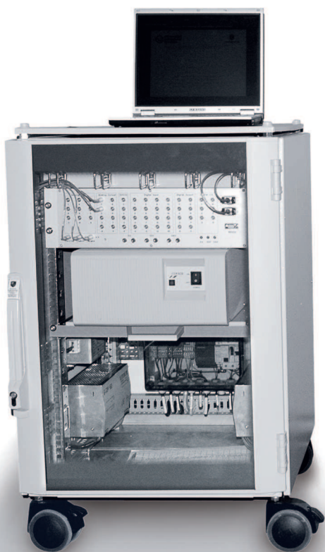
Von Porsche Engineering entwickelter Schaltkraftsimulator der 2. Generation bietet erweitertes Anwendungsspektrum
