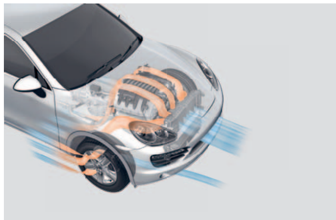
Effiziente Kühlerdurchströmung reduziert den Gesamtluftwiderstand.
